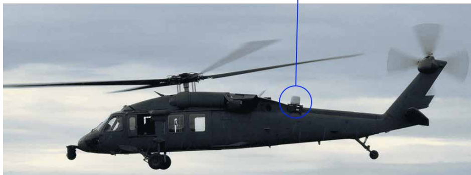
Ovzon Mini OMT – erfolgreicher Flug auf UH-60, 17/17 Mbps durch die Rotoren
